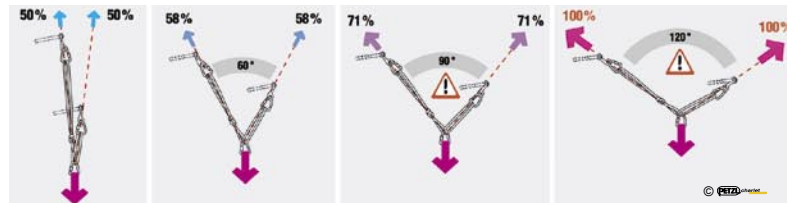
Kräfteverteilung einer Ausgleichsverankerung (Kräftedreieck)
